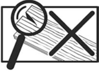
O revestimento do pavimento deve ser examinado antes da instalação para detetar quaisquer defeitos visíveis. Os pavimentos devem pertencer ao mesmo lote de produção. Se existirem defeitos visíveis, por favor informe a GERFLOR e não inicie a instalação sem a sua aprovação prévia.
